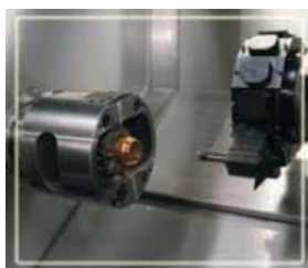
špeciálne indexové skľučovadlo SMW AXN nastaviteľné v 4 pozíciách
