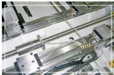
Centrálne mazanie valčekového vedenia a presných guľôčkových skrutiek
